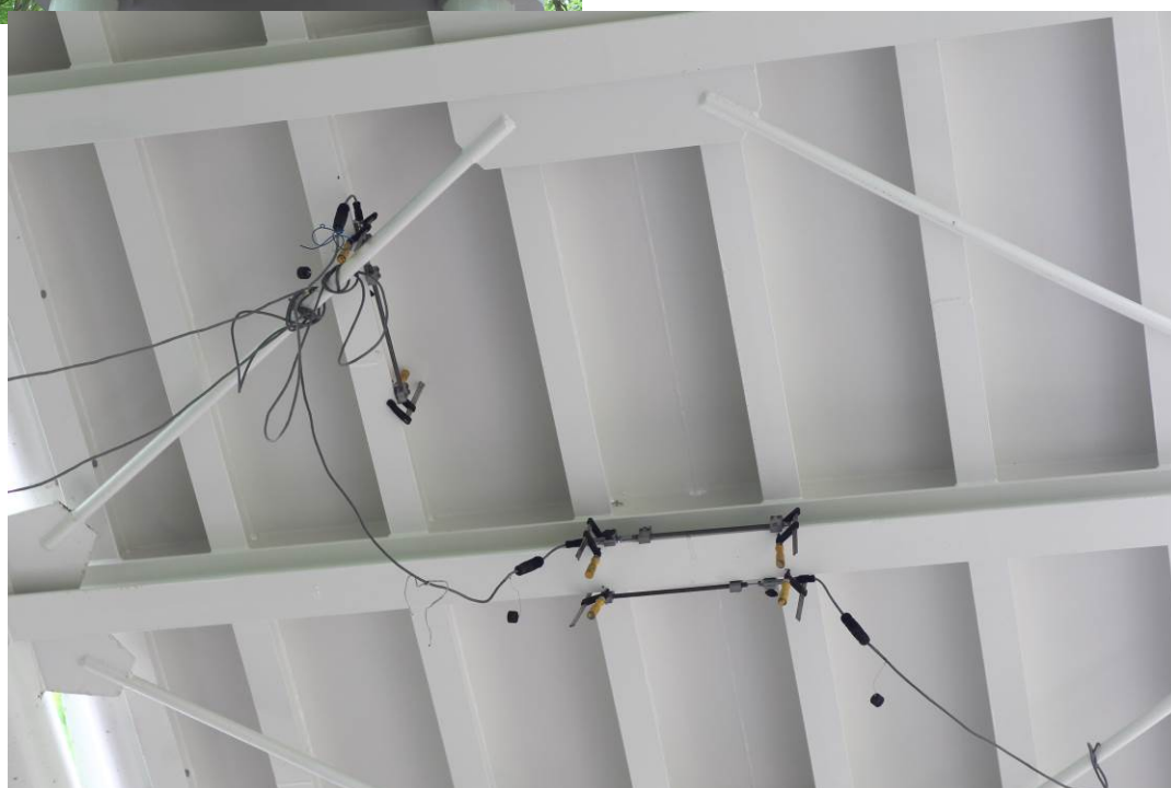
Fot.3 Ekstensometry indukcyjne związane na poprzecznicę pomostu i stężeniu do pomiaru wydłużeń
