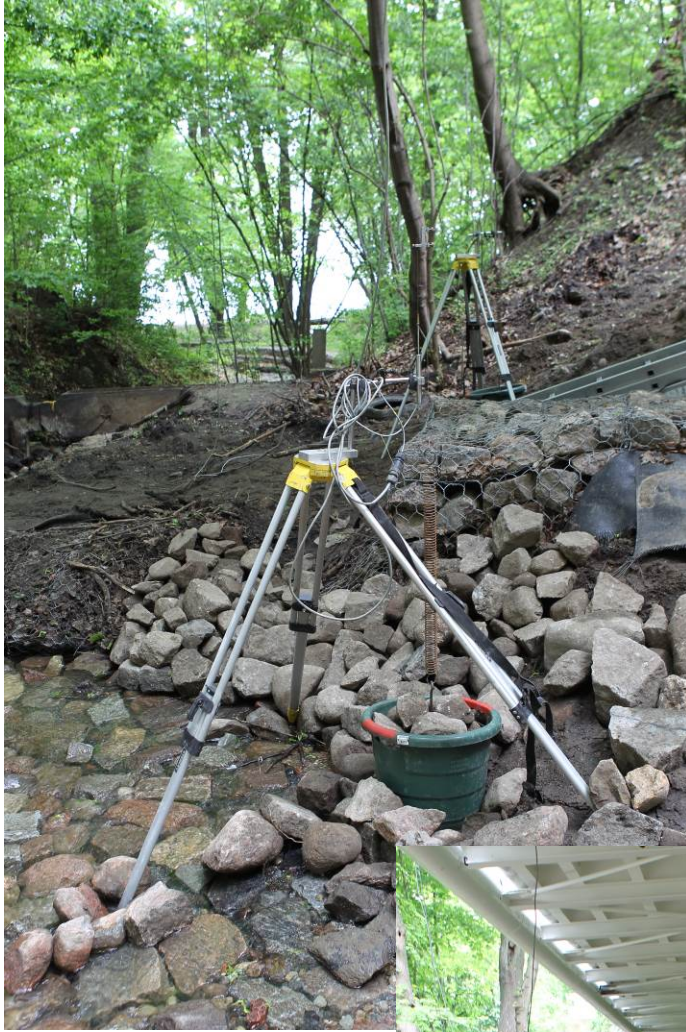
Fot.4 Czujnik indukcyjny służący do pomiaru przemieszczeń ( 1 czujnik do pomiaru przemieszczeń tylko 1 punktu pomiarowego konstrukcji )
