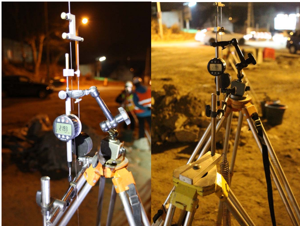
Rys. 1.1.-1.2. Czujniki zegarowe do pomiaru ugięć ZBT PŚ oraz LBT PG , źródło [MM]
