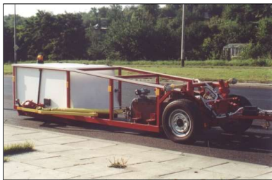
Rys. 3. Przyczepa do badań hałasu i przyczepności
