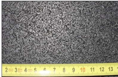
Rys. 4. Prototypowa nawierzchnia poroelastyczna
