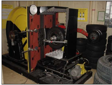
Rys. 1. Stanowisko do badań hałasu i oporu toczenia opon do samochodów osobowych i dostawczych
