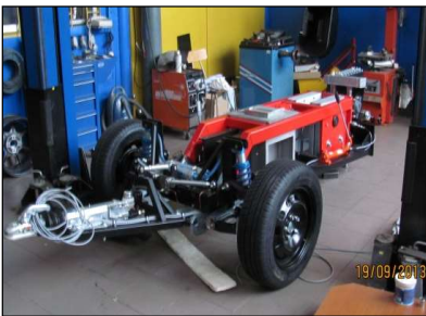
Rys. 5. Przyczepa do badań oporu toczenia opon
