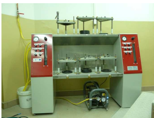
Aparat do badania wodoszczelności betonu oraz głębokości penetracji wody
