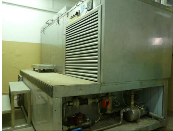
Automatyczna komora do badania mrozoodporności betonu o pojemności wsadu 200 l
