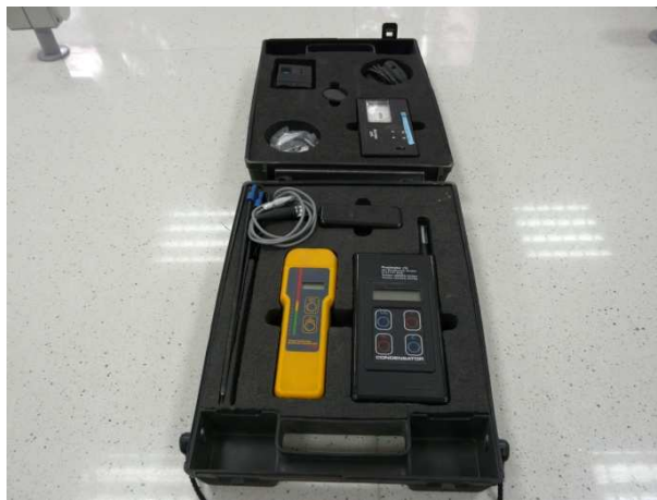
Wilgotnościomierz do badania poziomu zawilgocenia materiałów budowlanych
