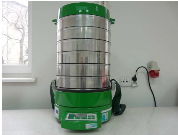
Wyrząsarka mechaniczna z zestawem sit normowych do badań kruszyw
