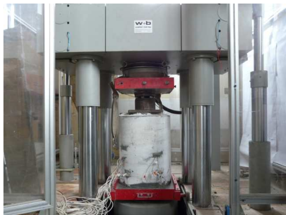
Prasa wytrzymałościowa Walter + Bai AG o max sile 6000 kN
