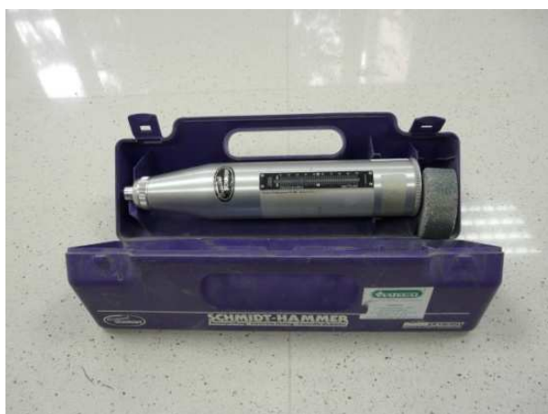
Młotek Schmidta do nieniszczących badań wytrzymałości betonu
