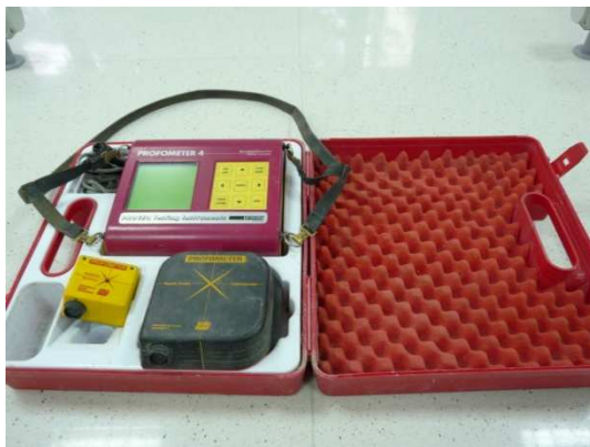
Aparat do pomiarów grubości otuliny prętów zbrojeniowych i średnic zbrojenia w konstrukcji
