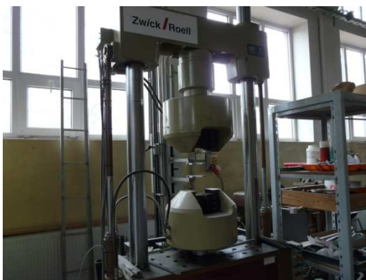
Maszyna wytrzymałościowa Zwick/Roell do badania stali z ekstensometrem mechanicznym
