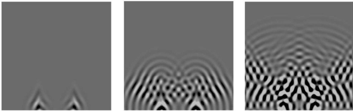
Rysunek 9: Pola prędkości przemieszczeń ( V_2 ) w płaszczyźnie środkowej blachy węzłowej dla modelu z poprzecznymi spoinami w chwili czasowej: a) 4 \cdot 10^{-5} s, b) 6 \cdot 10^{-5} s oraz 8 \cdot 10^{-5} s
