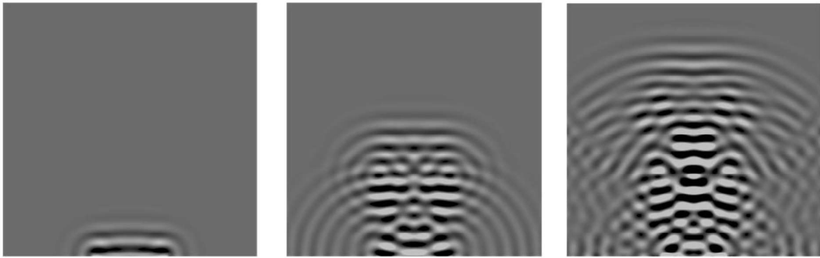
Rysunek 9: Pola prędkości przemieszczeń ( V_2 ) w płaszczyźnie środkowej blachy węzłowej dla modelu z poprzecznymi spoinami w chwili czasowej: a) 4 \cdot 10^{-5} s, b) 6 \cdot 10^{-5} s oraz 8 \cdot 10^{-5} s
