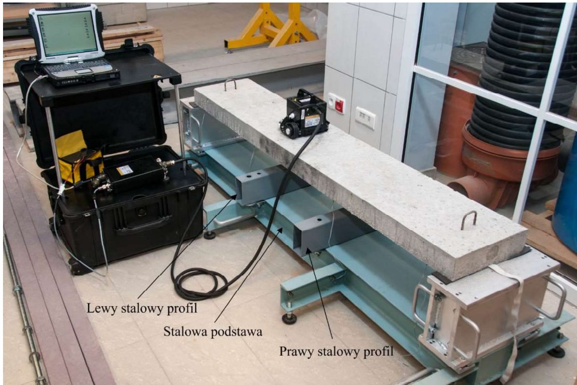
Rysunek 6: Stanowisko pomiarowe w badaniach płyty żelbetowej bez wykorzystania maty PSG (badanie nr 2)
