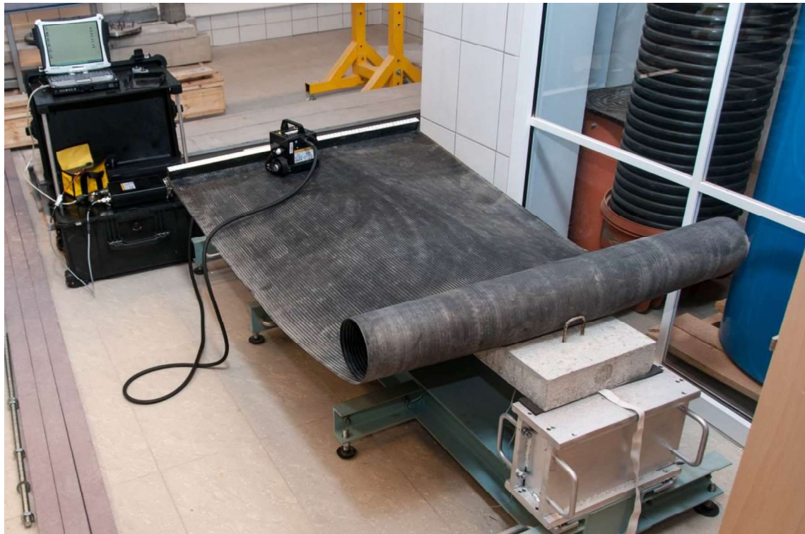
Rysunek 5: Stanowisko pomiarowe w badaniach płyty żelbetowej z wykorzystaniem maty PSG (badanie nr 1)
