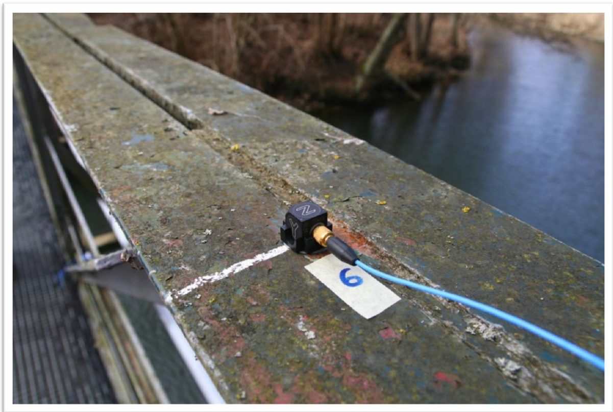
Punkt pomiarowy nr 6 – akcelerometr mierzący przyspieszenie w kierunku pionowym (Z) i bocznym (Y)
