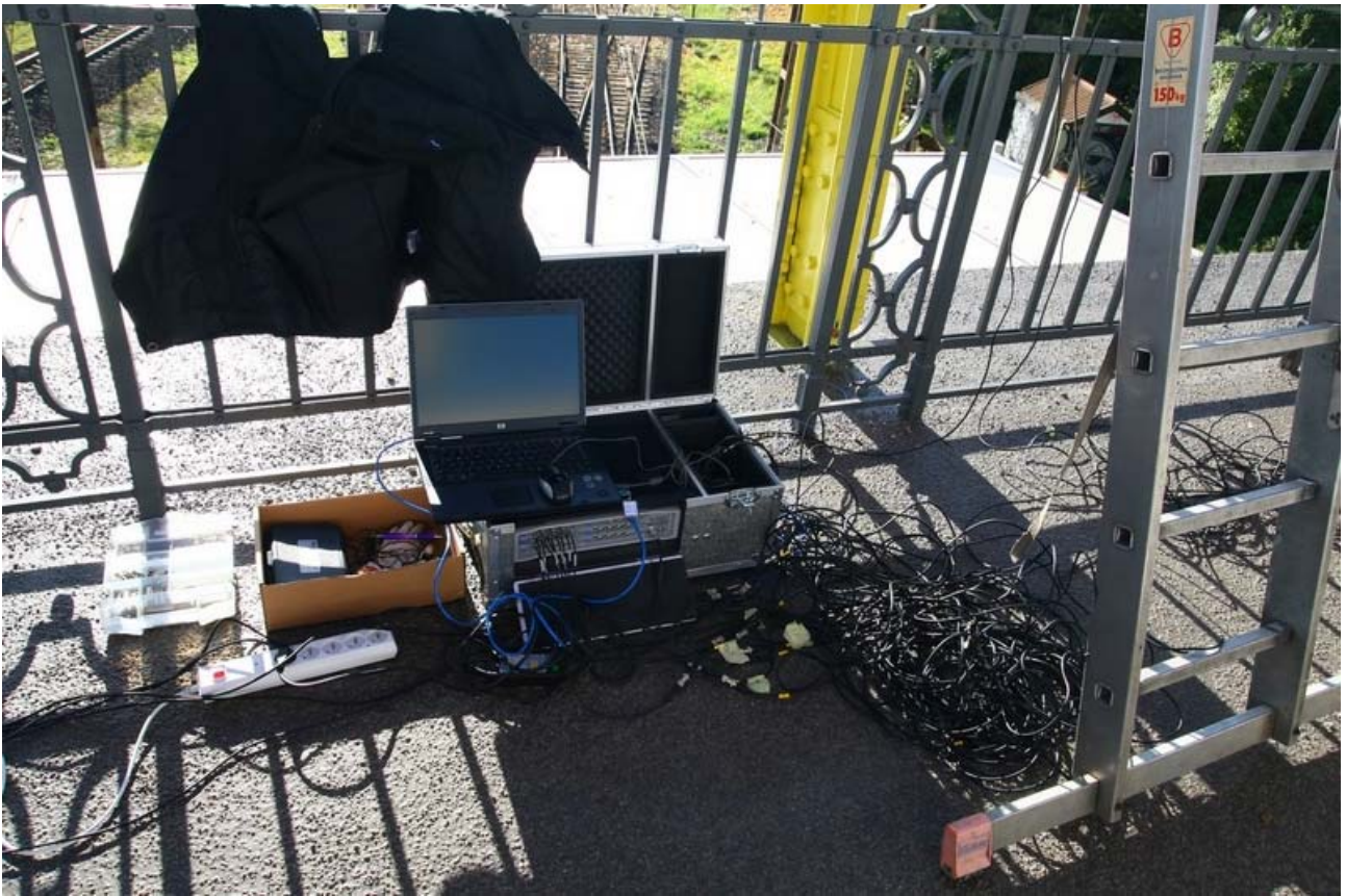
Fot. 3. Stanowisko pomiarowe - analizator drgań
