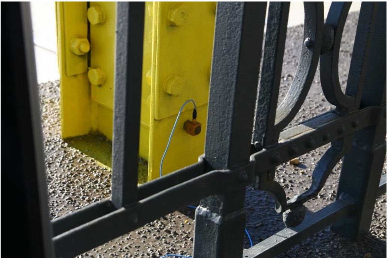
Fot. 2. Rozmieszczenie akcelerometrów w punktach pomiarowych
